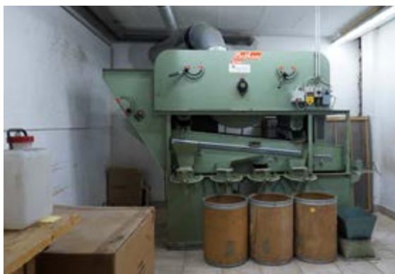
Abb.9.3: Die Maschine zur Saatgutreinigung im Forstgarten Nikolsdorf
